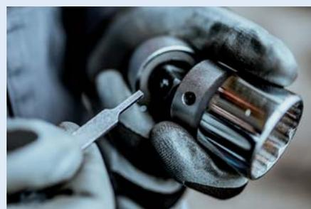
При установке головок или удлинителей положение отверстия в головке должно совпадать с положением штифта на приводном квадрате. При помощи ключа для смены торцевых головок (артикул 1111) надавите на штифт, одновременно надевая торцевую головку. Убедитесь, что штифт вошел в отверстие на головке.
